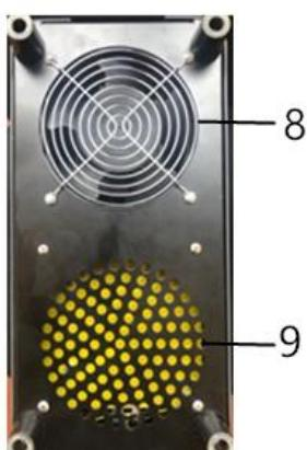
7. 风扇：冷却干体炉及加热装置。
