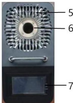
4. 温控显示屏：显示关于干体炉 PV 值，SV 值等信息。
