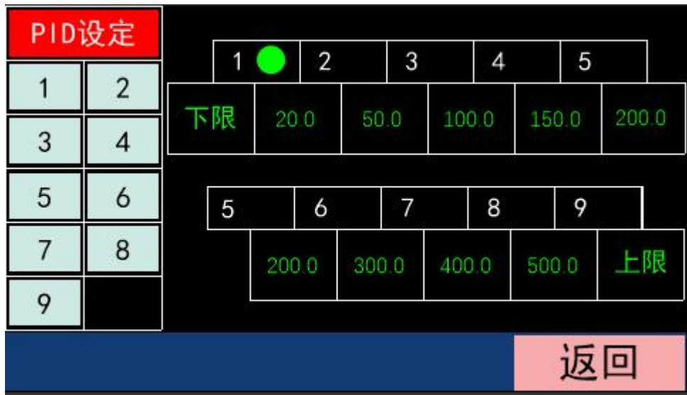
PID 设定内的数值出厂时已经预置好参数，合理的数值可以完善的结局超调和振荡现象，同时获得较好的响应速度，建议在预设值基础上修改。
